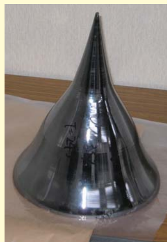
シリコンのインゴット。これをスライスしてシリコンウエハーが作られる
