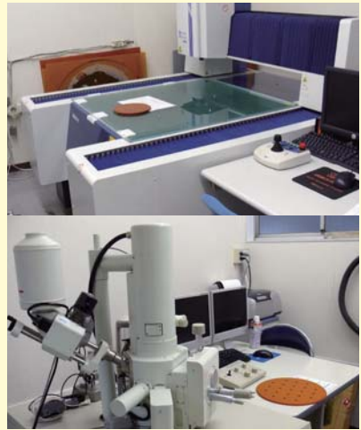
三次元測定機(上)と成分分析器の付いた電子顕微鏡(下)
