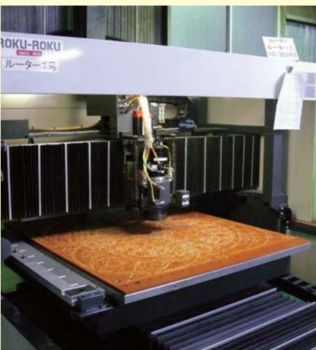
ルーター。プラスチック板の切削加工に使用される
