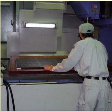
マシニングセンタ。金属の切削加工を担う。社長考案のバキュームによる加工物固定の機構がこの機械にも付加されている
